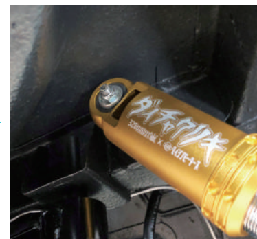
装上部取付後
