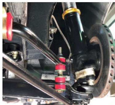
フロント サスペンション 取り付け後
